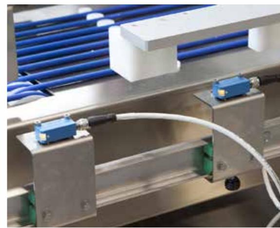
Fotocellule per il posizionamento delle vaschette / Trays positioning photocells system / Cellules photoélectriques pour la mise en place des barquettes / Photozellen für die Positionierung der Schalen
