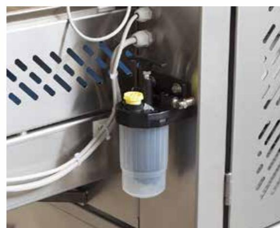
Pompa di lubrificazione manuale / Manual lubrication pump / Pompe de graissage manuelle / Manuelle Schmiermittelpumpe
