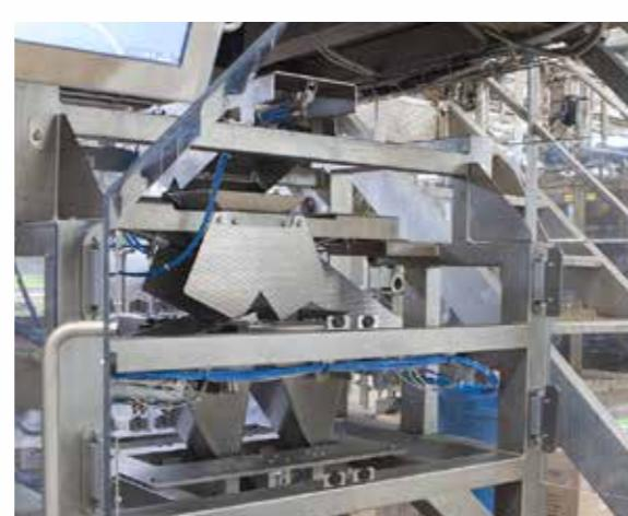
Dosatore Multitesta / Multihead doser system / Doseur multi-tête / Dosierung mittels Mehrfachkopf
