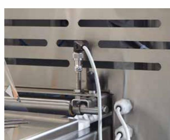
Proximity per la rottura film / Film alarm system / Capteur de proximité pour la rupture du film / Proximity für das Reißen des Films
