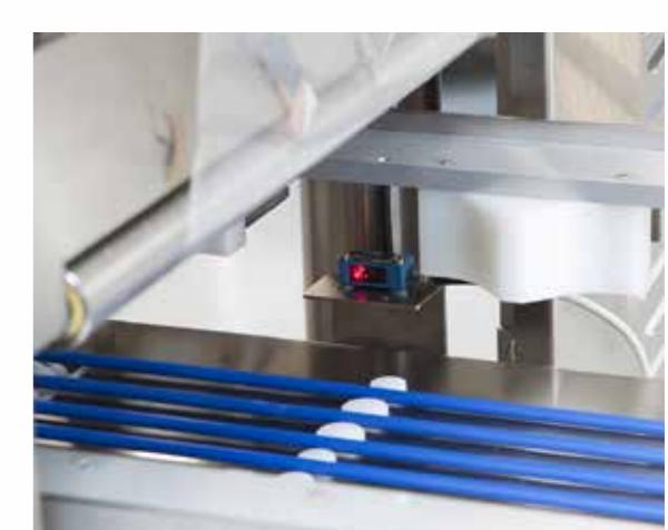
Fotocellula start ciclo / Cycle starting photocell / Photodétecteur démarrage du cycle / Fotozelle für den Zyklusstart
